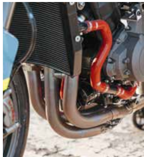
Akrapovic-Anlage mit Titankrümmer, Supersport-WM-Elektronik mit Spezial-Dashboard (rechts) von Bikeshop Lüchow
